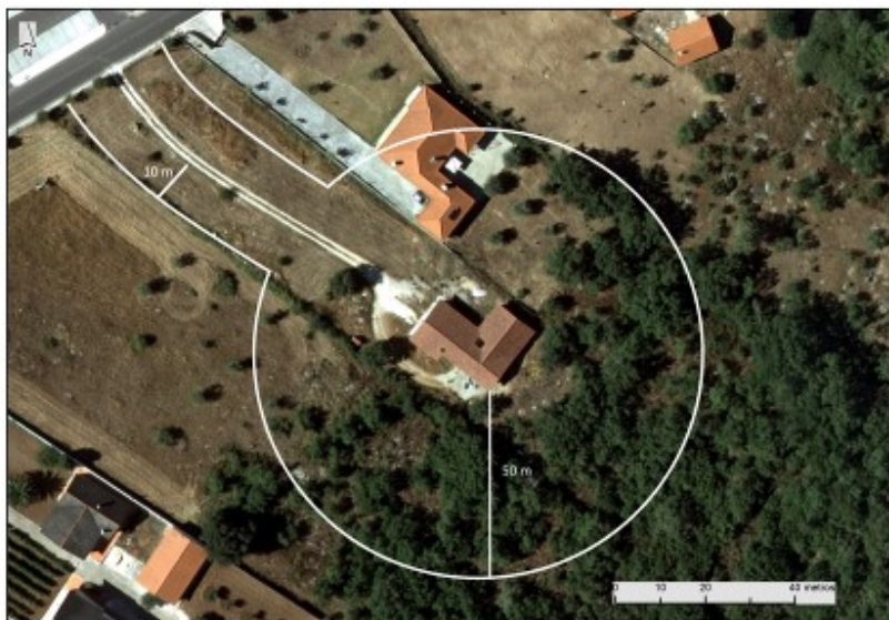
Figura 1 – Faixa de gestão de combustível – Casas isoladas
